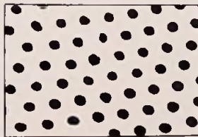
Fig. 1. Schematische voorstelling van een hexagonale pakking van magnetische bobbels; H_0 is het bekrachtigingsveld.
